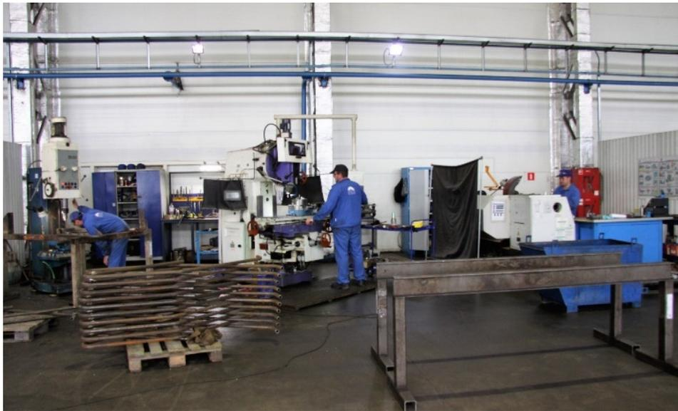
2. **Сварочно-сборочный участок** (сварка, макетирование, сборка металлоконструкций и технологического оборудования)
